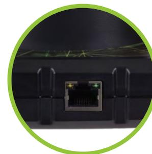
Grâce à une LED orange et à une LED verte, vous voyez si le CIP est correctement connecté au serveur de Car Lock Systems.
